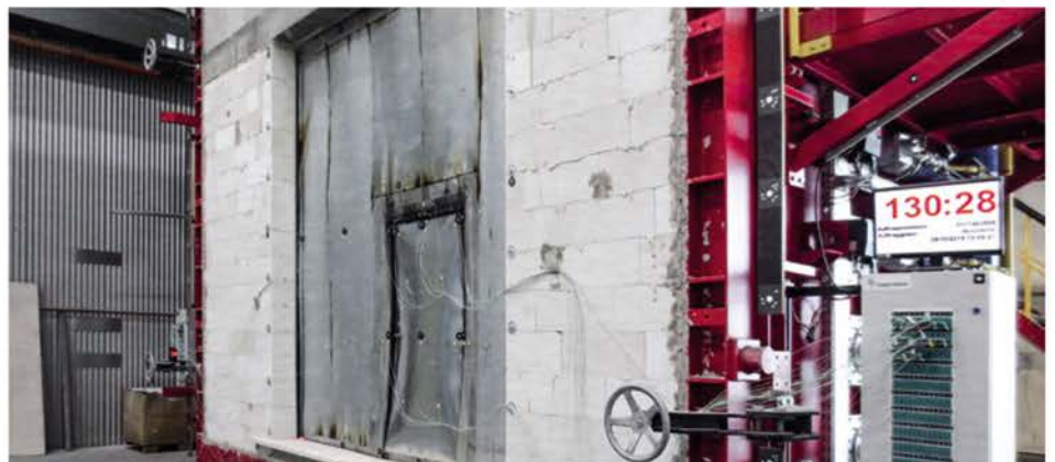
Branntest, resultat etter 130 minutter
